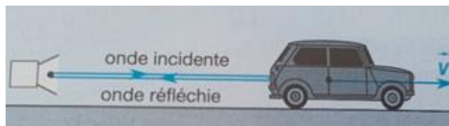
Figure 4. Schéma de principe de fonctionnement d'un radar
